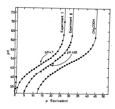
FIGURE 7. TITRATION CURVE OF THE COMPOUND AND ACETIC ACID.
